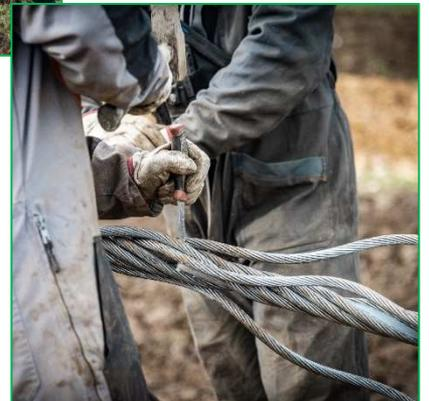
L'épissure est l'assemblage des deux extrémités du câble afin d'obtenir une boucle sans fin. Opération réalisée entièrement manuellement, l'épissure nécessite rigueur et savoir-faire pour que le point de raccordement des extrémités du câble soit invisible.
